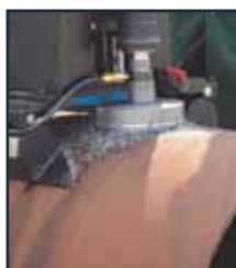
Silné dvojité trvalé magnety nepotřebují přívod ze sítě. Sebezamykací zařízení chrání před náhodným pohybem rukojeti nebo deaktivaci magnetu.
