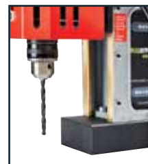
Maximální průměr vrtáku 13 mm.
