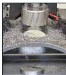
Dvojitá magnetická základna může být použita jak na konkávním nebo na konvexním povrchu
