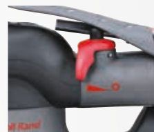
Vzduchový ventil regulující výkon
